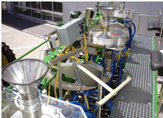
Bandköpfe mit elektrischem Antrieb und automatischen Hangausgleich (Serie)
